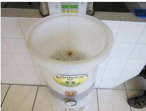
Würze in ein steriles 12/ 30/ 60l Gärfass abfüllen. Fass und Abfüllhilfen zuvor mit Desinfektionsmittel desinfizieren. Am Kesselboden befindliche Ausscheidungen nicht mit abfüllen. 11g Trockenhefe in die Würze geben und Gärfass mit Gärspund und oben eingefüllter schwefliger Säure verschließen.
