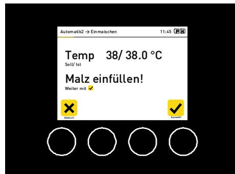
Mit Erreichen der Einmaischtemperatur ertönt ein Signalton und die Beleuchtungselemente blinken, was mit *Auswahl* quittiert werden muß. Die Pumpe wird dadurch abgeschaltet. Nun folgen Sie den Anweisungen der Brausteuerung.
