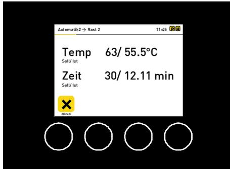
Die Anzeige zeigt nun die Rast, Soll- und Ist-Temperatur und die Soll- und Ist-Zeit. Nach Erreichen der Soll-Temperatur startet die Zeitzählung. Die weiteren Phasen werden vollautomatisch abgearbeitet. Das Display zeigt dabei auch jeweils die entsprechenden Zeiten und Temperaturen.
