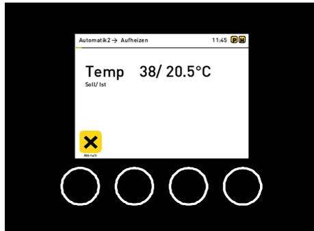
Pumpe und Heizung sind bis zum Erreichen der programmierten Einmaischtemperatur eingeschaltet. Die (P)umpen- und (H)eizungssymbole leuchten gelb. Auf dem Display wird die Soll- und Ist-Temperatur angezeigt. In der oberen Statusanzeige wird der Status z. B. Automatik3 angezeigt, was bedeutet, dass die Brauautomatik mit Rezept 3 gestartet wurde. Danach kommt der Hinweis in welcher Phase sich das Programm befindet.
