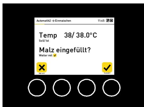
Wenn Sie das Malz eingefüllt haben quittieren Sie das mit *Auswahl*. Zur Sicherheit erfolgt nochmals die Abfrage „Malz eingefüllt?“. Mit *Auswahl* starten Sie nun den eigentlichen Brauprozess mit dem Braumeister. Die Pumpe und Heizung schaltet ein. Die Würze steigt im Rohr auf und läuft über. Der Kreislauf ist entstanden und das Malz wird durch das Umpumpen über die nächsten Phasen ausgewaschen.
