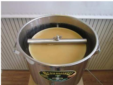
Die Automatik nun mit *Auswahl* fortsetzen. Hell gefärbtes Brauwasser steigt auf und läuft über. Der Kreislauf hat begonnen. Die nächsten Brauphasen werden vollautomatisch gemäß Programm durchlaufen. Während einiger Brauphasen erfolgt per Steuerung eine kurze Pumpenpause, um das Malz neu zu positionieren. Das Display zeigt die Ist- und Solltemperaturen sowie die Soll- und Ist-Laufzeit jeder Phase an.
