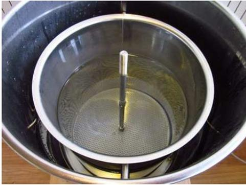
Mit Erreichen der Einmaischtemperatur ertönt ein Signalton, welchen Sie mit *Auswahl* quittieren. Nun das Malzrohr einsetzen (mit aufgezogener Dichtung nach unten). Darauf achten, dass Dichtung mit Malzrohr zentriert und absolut eben auf dem Kesselboden aufsitzt. Siebblech bis auf unteren Rand einschieben (Rohr nach oben). Darauf Feinsieb einlegen (im Wasser unten auflegen).
