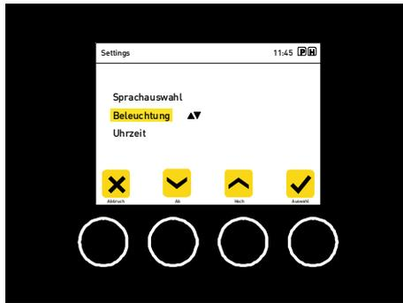
Aus dem Startmenü gelangen Sie über den Knopf *Einstellungen* in das Menü zum Einstellen der Sprache, Beleuchtung und der Uhrzeit. Mit den Pfeiltasten wählen Sie aus und mit *Auswahl* gelangen Sie zu den Auswahlmöglichkeiten, welche wiederum mit den Pfeiltasten gewechselt werden können. Die gewünschte Auswahl mit *Auswahl* bestätigen. Mit *Abbruch* kommen Sie wieder zurück in das Startmenü.
