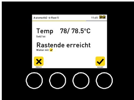
Nach Ablauf der programmierten Brauphasen ertönt wiederum ein Signalton. Dieser wird auch mit *Auswahl* quittiert. Die Pumpe schaltet ab und man wird zum sogenannten Abläutern („Malzrohr entnehmen“) aufgefordert. Abläutern nennt man das Trennen des Malzschrotes von der Bierwürze. Das Läutern mit dem Braumeister ist im Vergleich zu vielen anderen Hausbraumethoden eine relativ einfache, schnelle und saubere Angelegenheit und stellt ein zentrales Konzept
