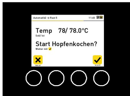
Nach Entfernen des Malzrohres quittieren Sie dies wieder mit *Auswahl*. Zum starten des Hopfenkochens drücken Sie nochmals *Auswahl*. Pumpe und Heizung schalten sich wieder ein und die Automatik wird fortgesetzt.
