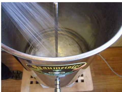
12l/ 23l/ 55l Brauwasser einfüllen – bei 20l ca. 2cm unter der oberen Markierung an der Zugstange. Folgen Sie den Anweisungen der Brausteuerung, indem Sie mit *Auswahl* quittieren, daß Wasser eingefüllt ist. Die Pumpe entlüftet selbstständig und die programmierte Einmischtemperatur wird angefahren.
