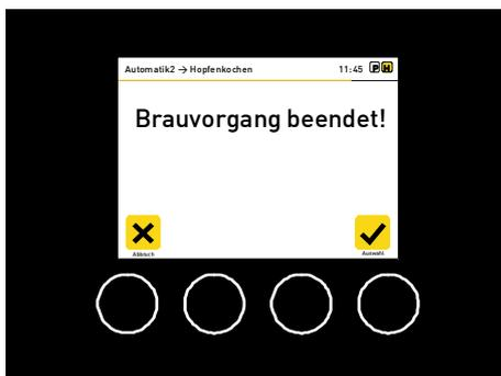
Mit Ablauf der Kochzeit ertönt wieder ein Signalton, der das Ende des Brauvorgangs anzeigt. Dies wird mit *Auswahl* quittiert. Die Heizung wird abgeschaltet.
